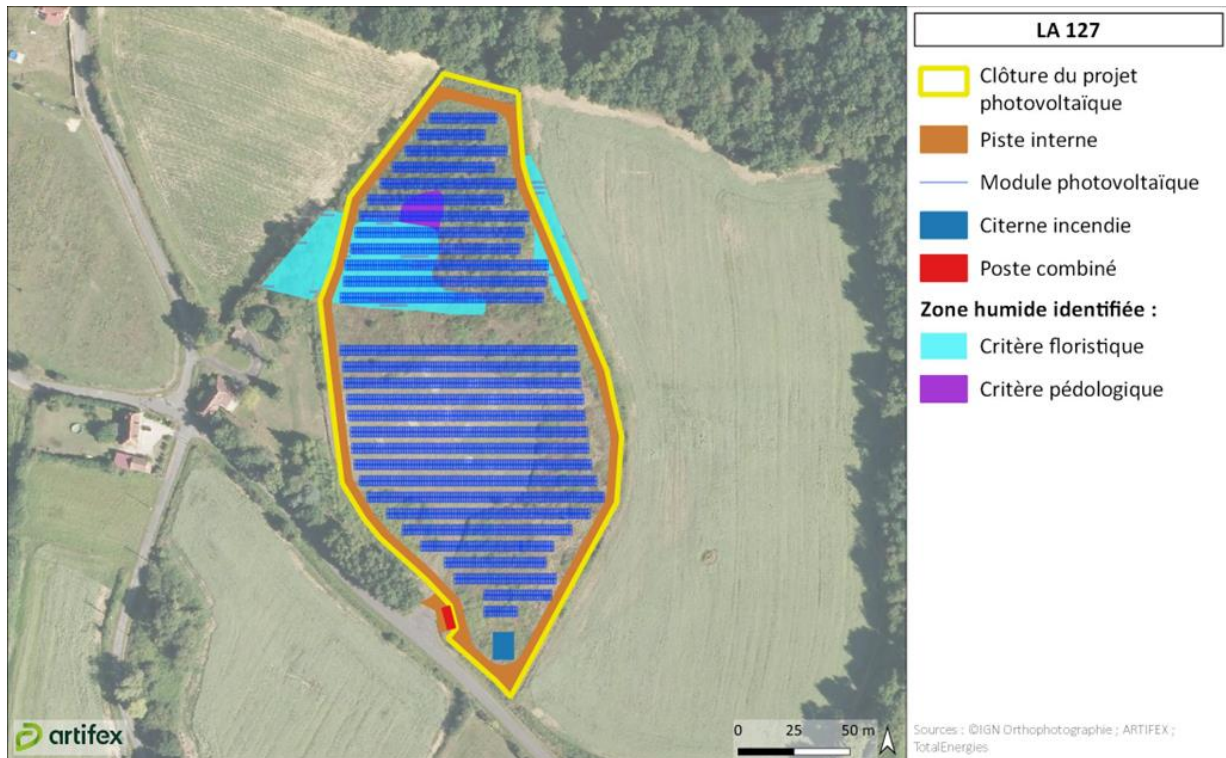
Figure 10 : Zones humides au droit du projet - site LA127 (ARTIFEX 2022)
