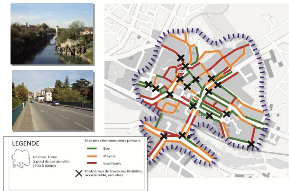
État des cheminements piétons du centre ville d'Orthez
